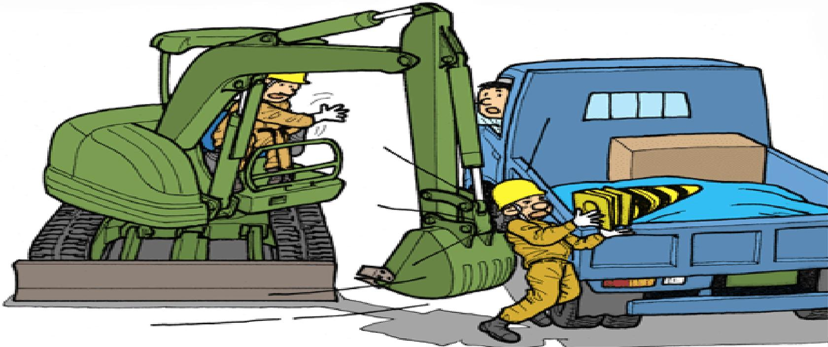
**Consigli** 1. Nel fermare una pala, abbassare il braccio, bloccare il controllo delle leve e spengere il motore. 2. Mantenere bene abbottonati i propri indumenti da lavoro. 3. Uscire sempre dal mezzo per prendere dei documenti
