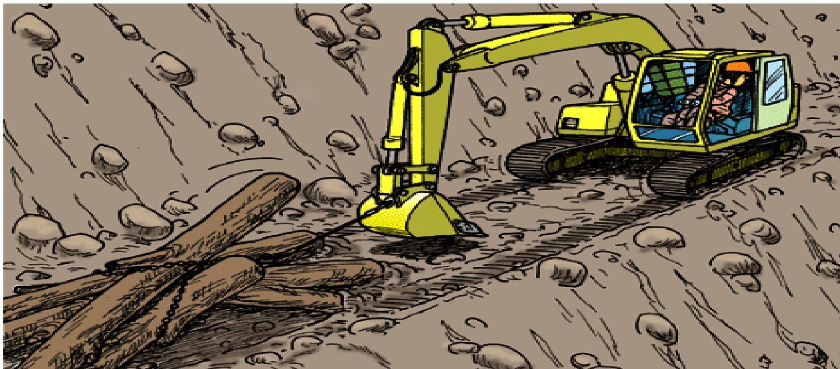
**Questo è l'incidente accaduto!** Il carico trascinato si è inclinato giù per il pendio trascinando il braccio dell'escavatore che ha perso stabilità e si è rovesciato uccidendo l'operatore alla guida
