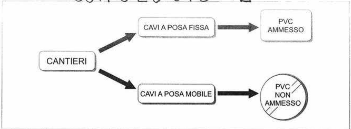
FIGURA 2.2 – Nei cantieri i cavi isolati e/o con guaina in PVC possono essere utilizzati soltanto per posa fissa.
