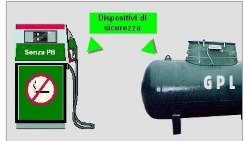
Per prevenire un incendio tali impianti o depositi vengono dotati di dispositivi di sicurezza di vario genere quali ad esempio: termostati, pressostati, interruttori di massimo livello, termocoppie per il controllo di bruciatori, dispositivi di allarme, sistemi di saturazione e sistemi di inertizzazione, etc.
