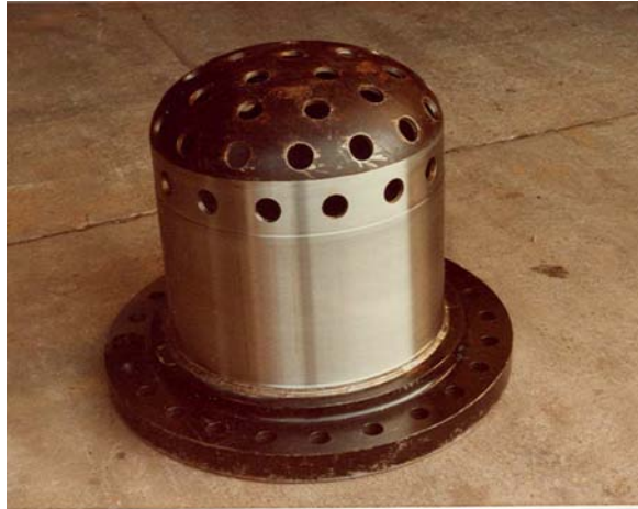
Figura 23.4 - Particolare di un espansore per scarico vapore.
