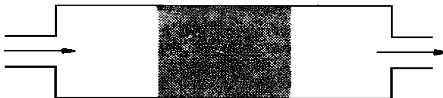
Figura 23.1 - Silenziatore a strozzamento.
