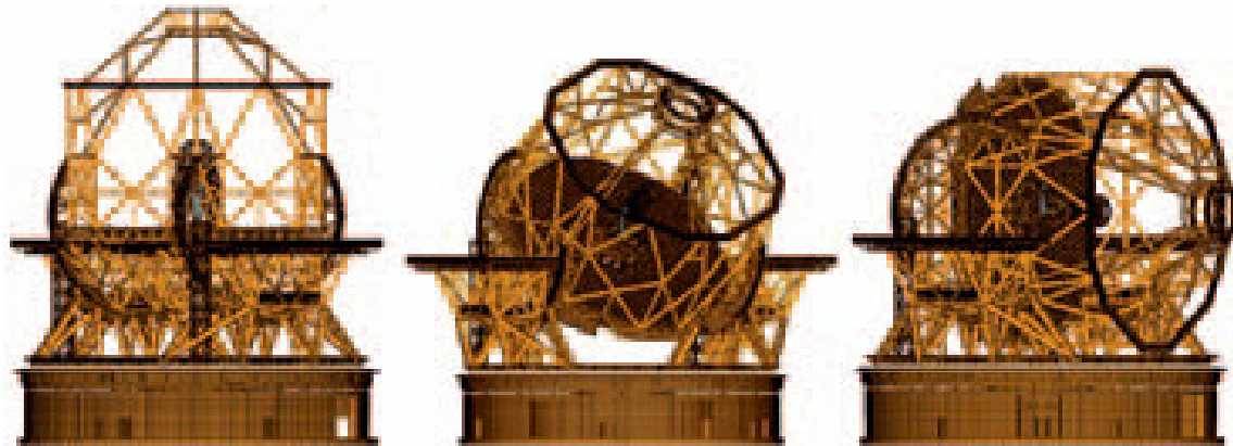
Modelli numerici del telescopio sviluppati con Midas Gen
