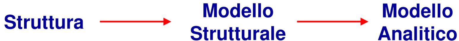
Anche se è possibile trovare la soluzione esatta del Modello Analitico, bisogna sempre interpretare i risultati in relazione alle approssimazioni fatte per passare dalla Struttura al Modello Strutturale e dal Modello Strutturale al Modello Analitico
