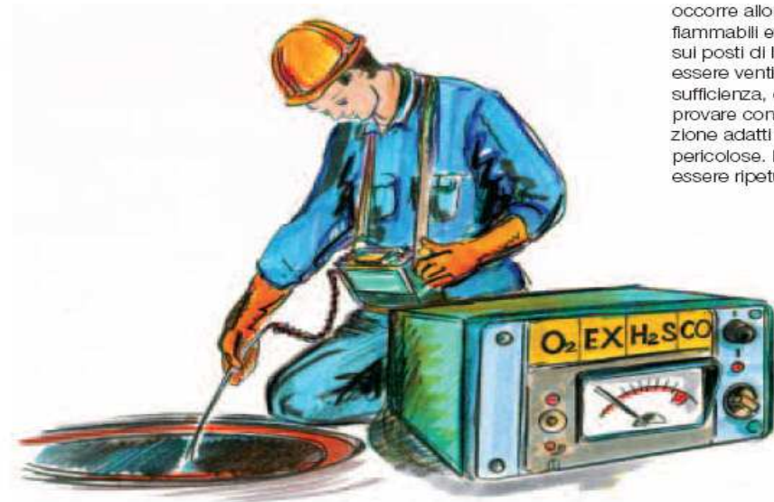
Figura 7: Prima di entrare nella canalizzazione si eseguono misurazioni per accertare l'eventuale presenza di ossigeno, gas e vapori infiammabili, idrogeno solforato, monossido di carbonio.
