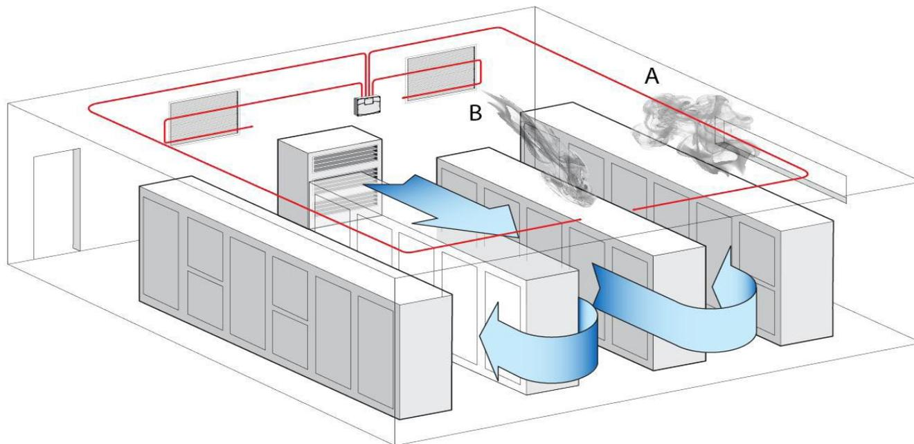
**Nella protezione di un centro di elaborazione dati si può aggiungere alla protezione ambiente la protezione delle macchine utilizzando delle diramazioni con capillare.**
