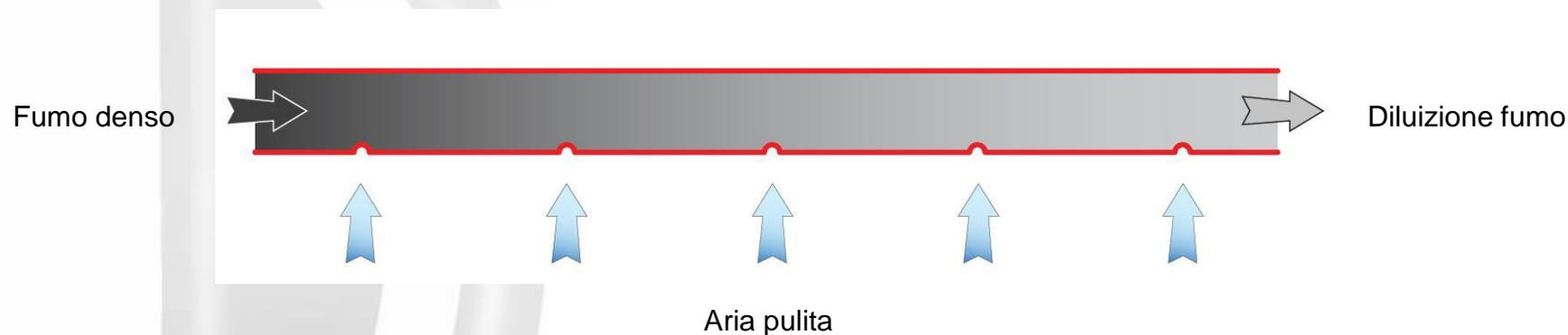
**Attenzione alla diluizione del fumo**, un oscuramento/metro del 2% a 100 metri può ridursi ad 1/20 (0,1%).
