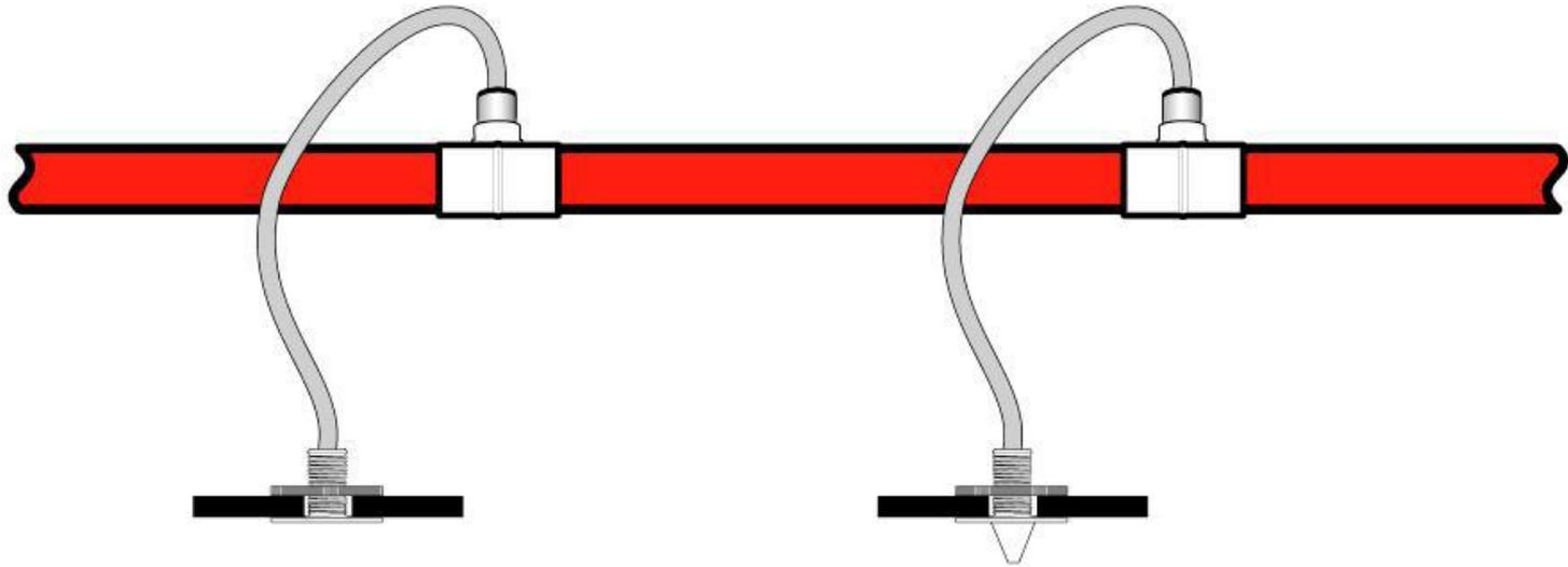
**Tali diramazioni con capillare devono essere realizzate con tubi di almeno 7mm interno e con diramazione non più lunga di 1,5 metri.**
