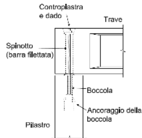
Figura 4: collegamento con spinotto
