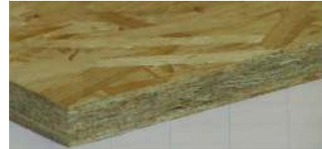
Sono solitamente prefabbricati, realizzati con travetti in legno massiccio o lamellare sui quali viene chiodato sopra e sotto un pannello di OSB o Multistrato.
