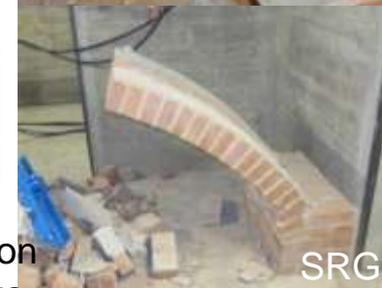
BTRM – rottura per blocchi rigidi, collasso fragile (4 cerniere)
