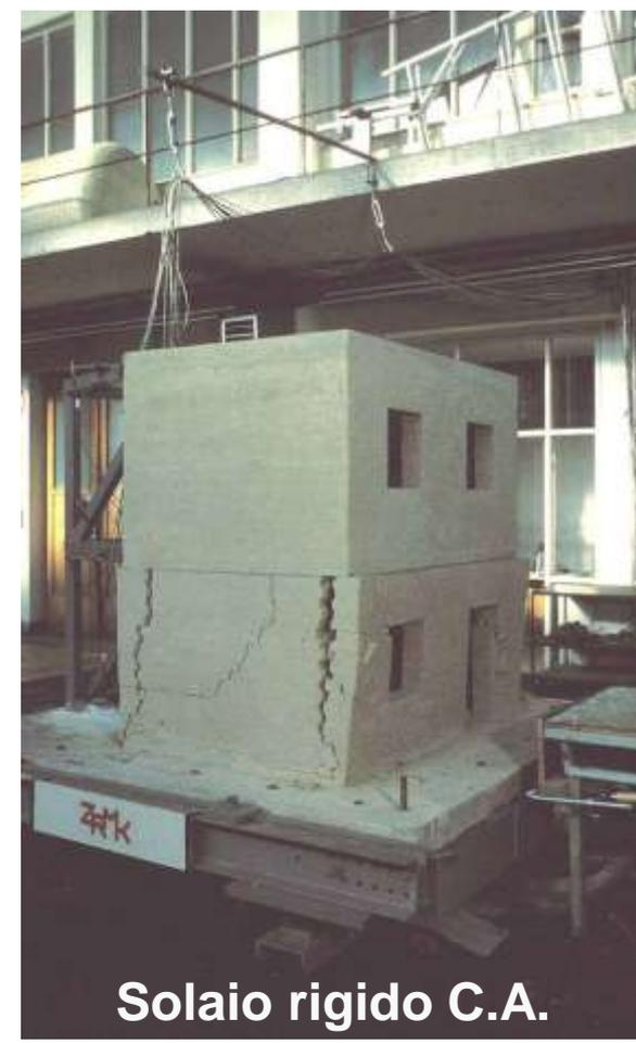
**Modello di edificio in muratura di mattoni senza tiranti, con tiranti e solai deformabili, con solaio rigido in c.a. dopo prove su tavola vibrante**
