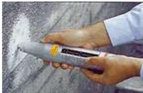
Metodi di prova non distruttivi (**prove soniche, prove sclerometriche, penetrometriche per la malta, ...**) o ulteriori indagini debolmente distruttive possono essere impiegati a complemento delle prove richieste.
