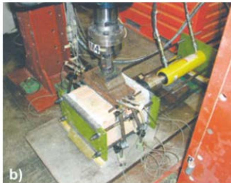
Fig. 4 - Prove di scorrimento a taglio secondo la UNI EN 1052-3: schema (a) e configurazione di prova (b).
